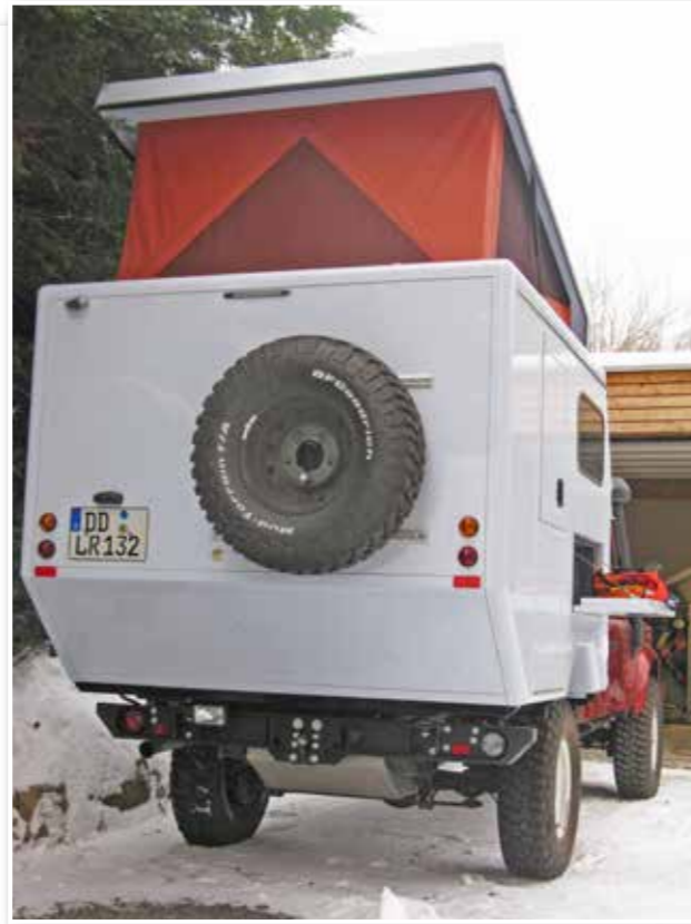
Das Zelt im Klappdeckel mit Fenstern und Mückengaze auf allen Seiten für ausreichend Ventilation
