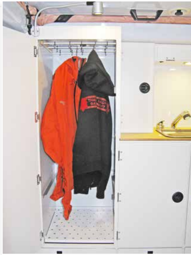
Kleiderschrank + Trockenschrank: Die Webasto pustet unten rein, oben führt ein Decksventilator die feuchte Abluft nach außen
